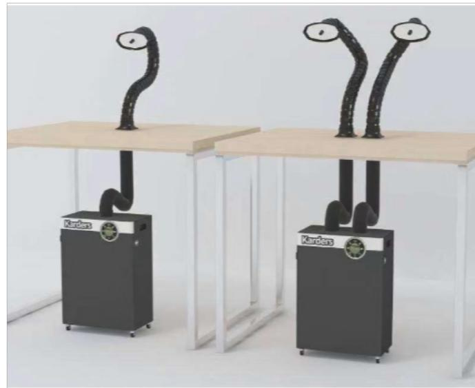
烟雾净化器主要用于焊接、抛光、切割、打磨等工序中产生烟尘和粉尘的净化以及对稀有金属、贵重物料的回收等，可净化大量悬浮在空气中对人体有害的细小金属颗粒。具有净化效率高、噪声低、使用灵活、占地面积小等特点。且设备操作简单，容易清理维护，经特殊减震降噪处理，保证了设备的噪音环保。烟雾净化器具有如此多的优点，它的工作原理是什么呢？怎么可以做到这些呢？烟雾净化器主要通过风机引力作用，焊烟废气经万向吸尘罩吸入设备进风口，设备进风口处设有阻火器，火花经阻火器被阻留，烟尘气体进入沉降室，利用重力，首先将粗粒尘直接降至灰斗，微粒烟尘被滤芯捕集在外表面，洁净气体经滤芯过滤净化后，由滤芯中心流入洁净室，洁净空气又经活性碳过滤器吸附进一步净化后经出风口达标排出。
